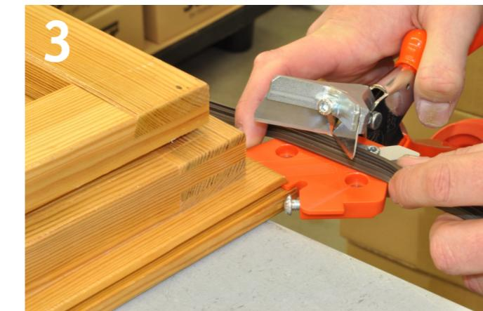
Auflagentisch in die Nut des Rahmens platzieren, ggf. mit Stellschraube das Maß justieren und die Dichtung an den Anschlag anlegen
