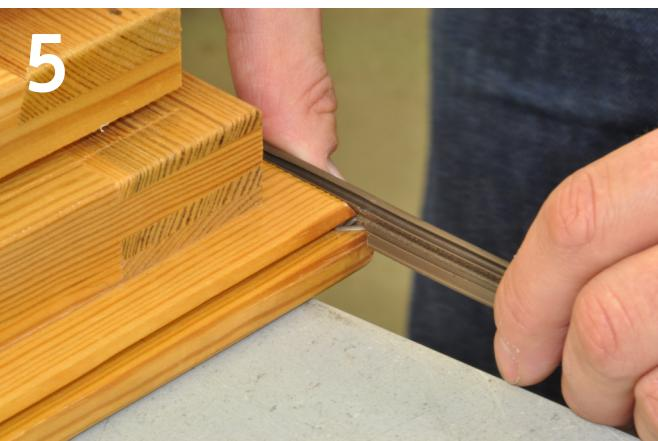
Dichtung bis zur ausklinkten Position in die Nut einziehen
